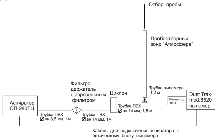
Рис.1 Схема сборки ОМПН-10.0.
